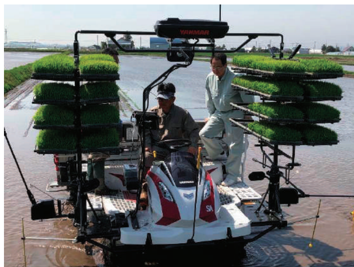
自動操舵システム搭載の田植機
